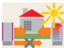
Zuerst wird die im Puffer gespeicherte Solarenergie genutzt, erst bei Bedarf schaltet sich die Hackgut- bzw. Pelletsanlage dazu, wobei die Wärme direkt in die Wohnung geht und nicht unnützlich im Puffer zwischengespeichert wird.
