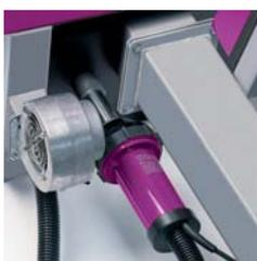
Das elektrische Zündungsgebläse wird von der Steuerung höchst effizient eingesetzt: Bei Anlagenstart und nach Betriebspausen läuft es dank der Glutüberwachung mittels Rauchgastemperaturfühler nur so lang wie nötig und hält dadurch den Stromverbrauch niedrig – bei voller Funktionssicherheit!
