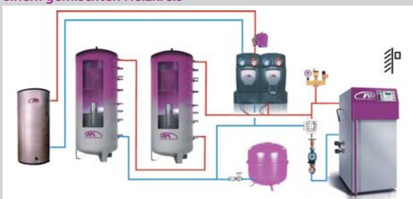
Scheitholzessel mit Frischwasserstation und einem gemischten Heizkreis
